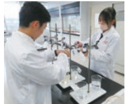
合成した吸水性ポリマーをお茶パックに入れ、吸水率を測定する
