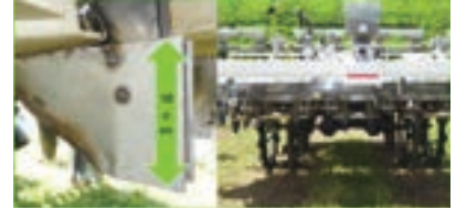
完成した深層元肥用の器具を取り付けた田植え機
